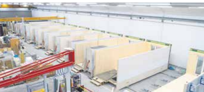
Bisherige Produktionsstätte mit 14 Arbeitsstationen: Hier wurden komplette Räume montiert, von der Holzwand bis zur Einbauküche.
